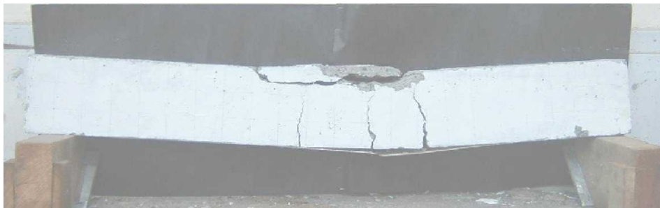
Gambar 8. Model Keruntuhan Balok Dengan Penambahan 1 Lapis GFRP (GFRP Putus)
